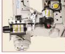
ULH: 電動壓腳升降裝置 Electric Presser foot Lifter
